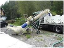
TRI 2200 Elévateur à poissons Ø380mm, L = 6 mètres SDK AS 06
