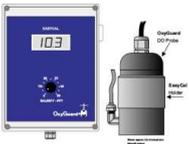
ANA 0900 Appareil de calibration Easy Cal, avec écran et compensat° sali
