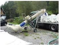
TRI 2100 Elévateur à poissons Ø380mm, L = 5 mètres SDK AS 05
