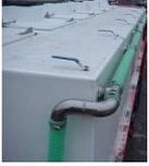
BAC 1595 Dispositif de rinçage lfw avec vanne
