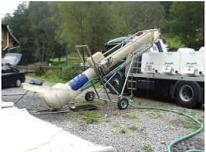
TRI 2300 Elévateur à poissons Ø380mm, L = 7 mètres
