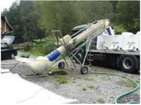
TRI 2000 Elévateur à poissons Ø380mm, L = 4 mètres SDK AS 04
